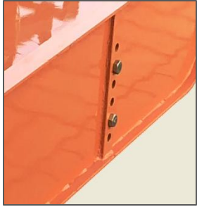
Cutting Height Adjustment / Réglage de la hauteur de coupe Ajuste de altura de corte / Ajuste de altura de corte
