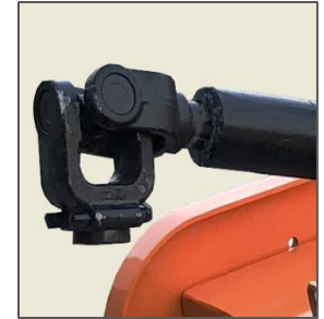
Telescopic PTO / Prise de force télescopique / PTO telescópico / Toma de fuerza telescópica
