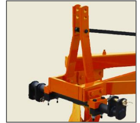
Shear Bolt for overload Protection / Boulon de cisaillement pour la protection contre les surcharges Parafuso de cisalhamento para proteção contra sobrecarga / Perno de corte para protección contra sobrecarga
